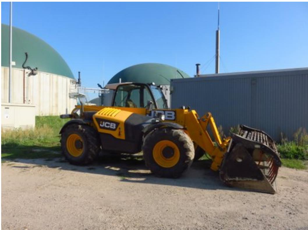
Abbildung 6: Teleskoplader
